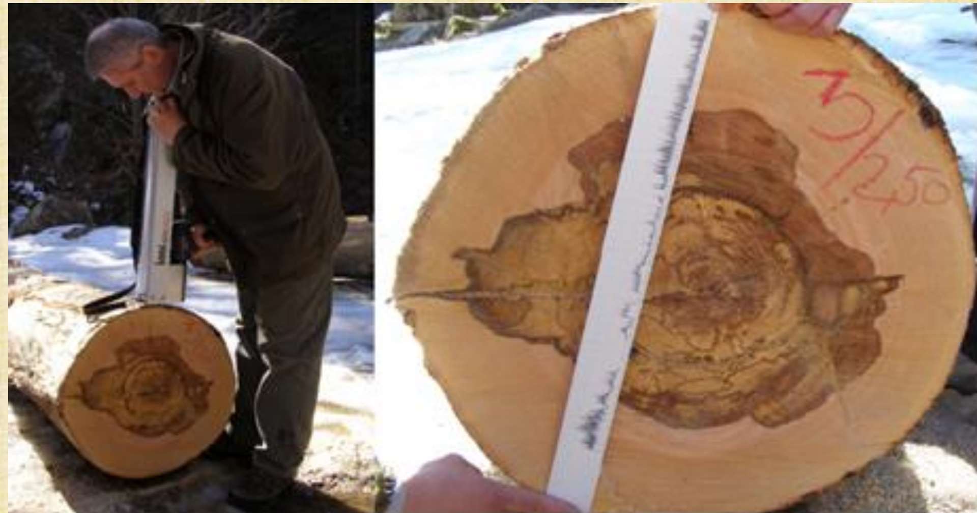
Fig. 2. Utilizarea Rezistografului IML RESIF500 – S la identificarea și măsurarea caracteristicilor defectelor care însoțesc gelivura
