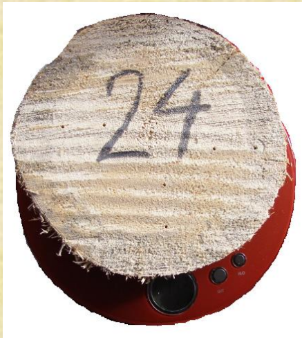
Cântărirea rondelelor preluate din piesele de probă
