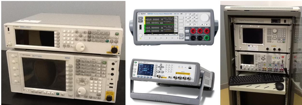
Fig.6 Sistem complex de analiză materială (analiză spectrală și impedanțmetrie până la 3,6 GHz)
