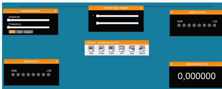
Fig.74 O posibilă interfața Web NI ELVIS (Osciloscopul acum este inactiv)
