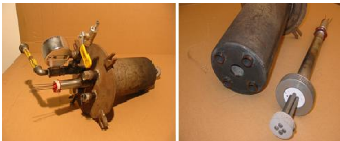
Fig.24 Senzorul de Nitrurare – doi electrozi pasivi și doi electrozi din oțelul ce se nitrurează
