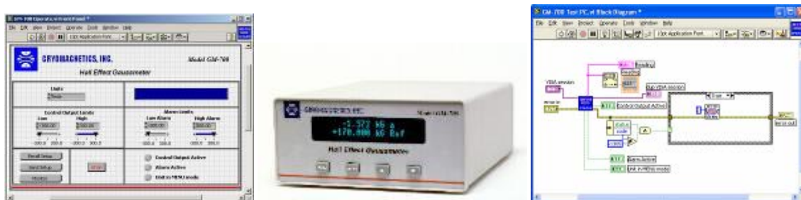
Fig.52 Sistem de control în LabVIEW pentru Gaussmetru GM-700
