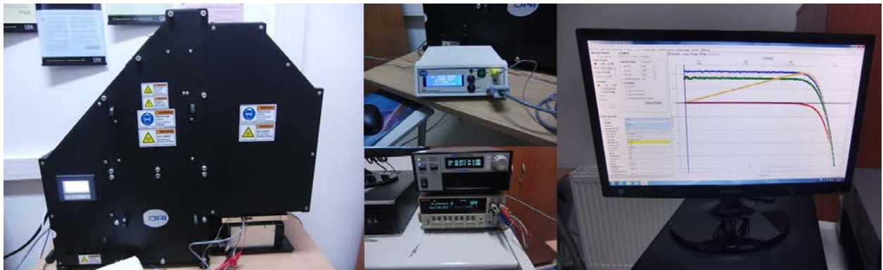
Fig.5 Simulator Solar Clasa A++AA, Control temperatură și Sistem caracterizare I-V
