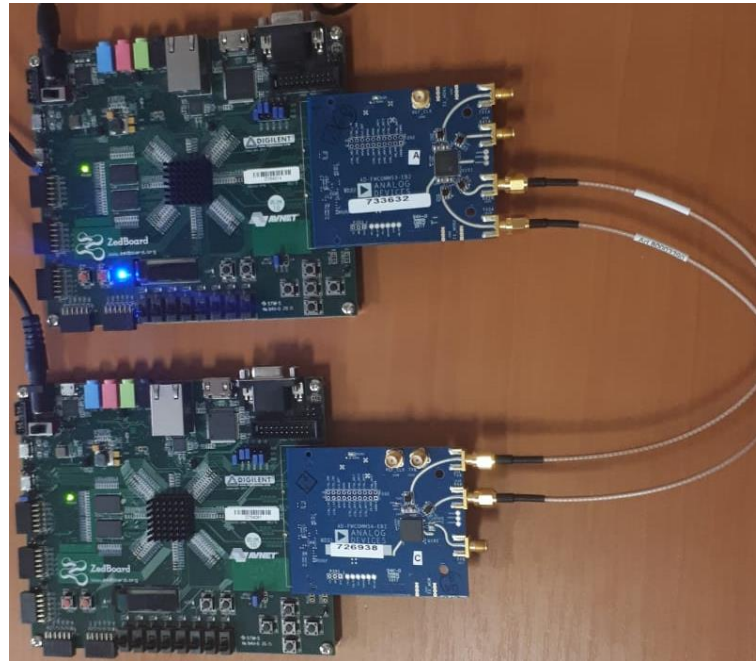
Prototip experimental– Back-to-back “Zedboards” cu plăcile adiționale radio anexate FMCOMMSx AD
