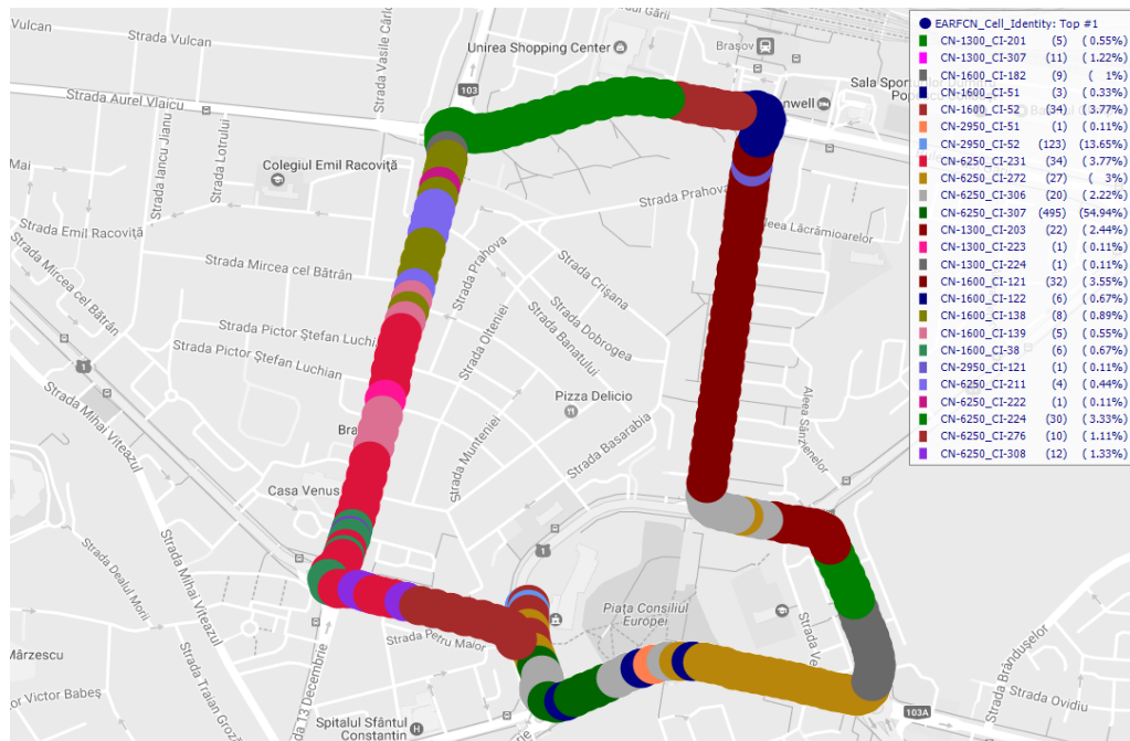
Fig. 9. – Ruta de testare cu evidențierea numerelor de canal diferite: EARFCN (Numărul absolut al canalului de radiofrecvență EUTRA)
