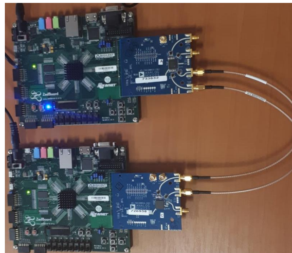
Fig. 51 Prototip experimental– Back-to-back "Zedboards" cu plăcile adiționale radio anexate FMCOMMSx AD
