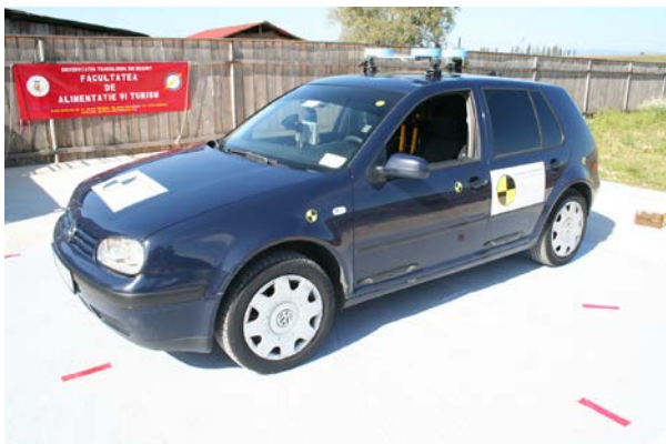
Fig. 4.3 Modul de amplasare a aparaturii pe autoturism
