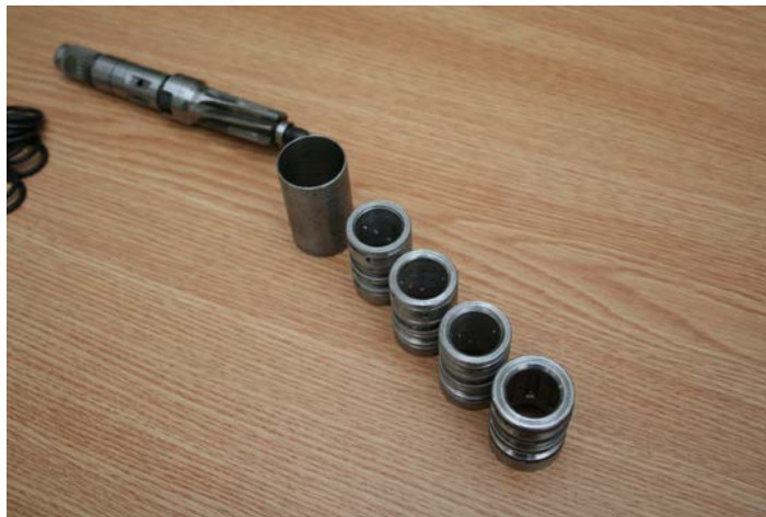
Fig. 3.7 Perechea piston-cilindru cu diametre diferite
