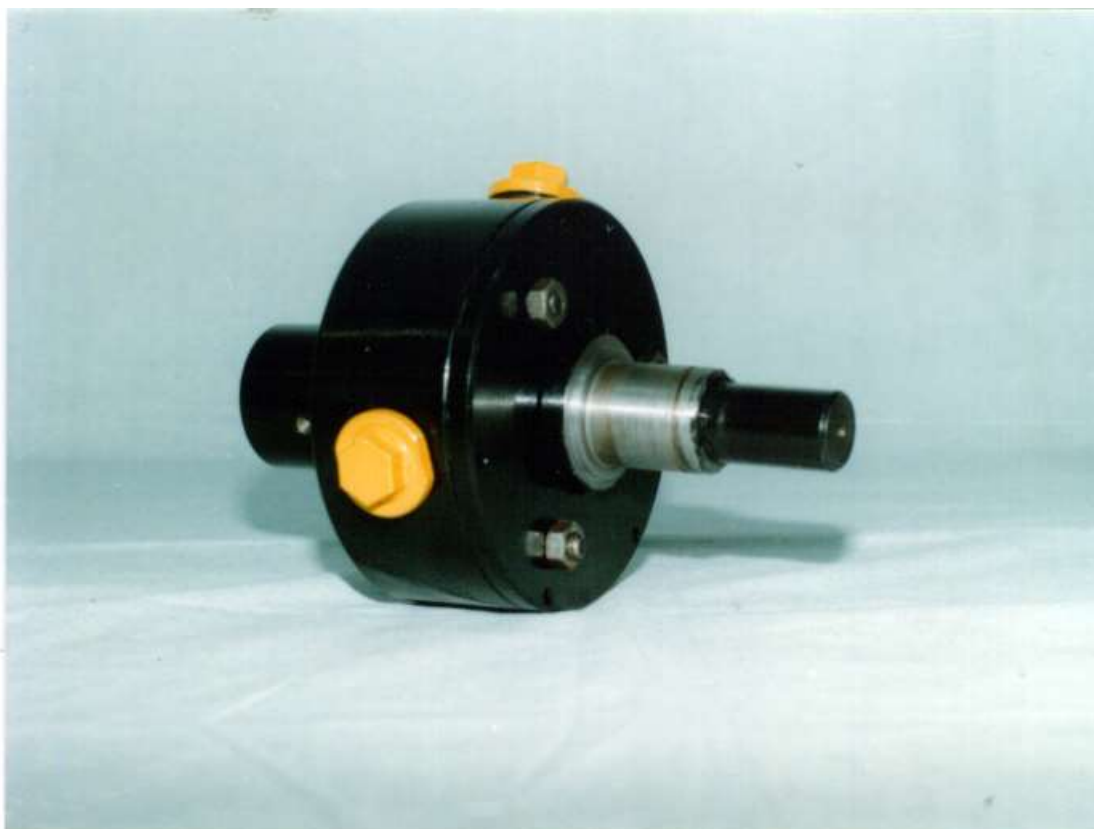
7.2. Cuplaje elastice și de siguranță cu arcuri lamelare dispuse echiunghiular
