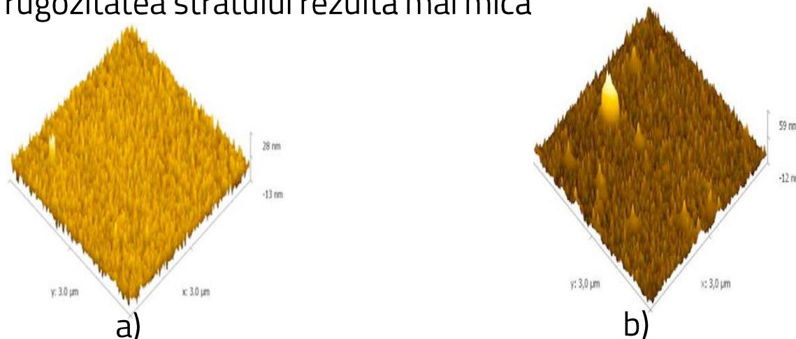
Fig54. Imagini AFM pentru două filme depuse pentru diferite distanțe țintă-substrat: a) 3 cm; b) 2 cm
