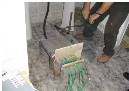
Fig. 1.32. Montajul pentru înregistrarea variației temperaturii în timpul răcirii
