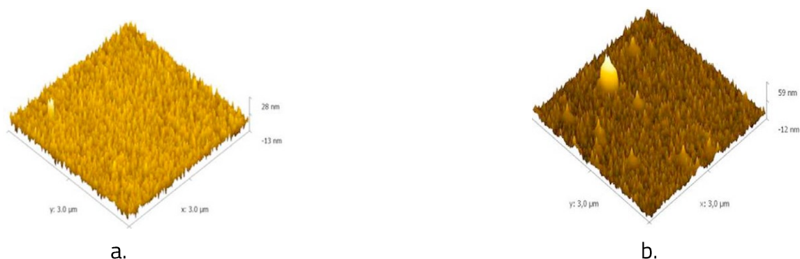
Fig. 3.18. Imagini AFM pentru două filme depuse pentru diferite distanțe țintă-substrat: a) 3 cm; b) 2 cm [54]
