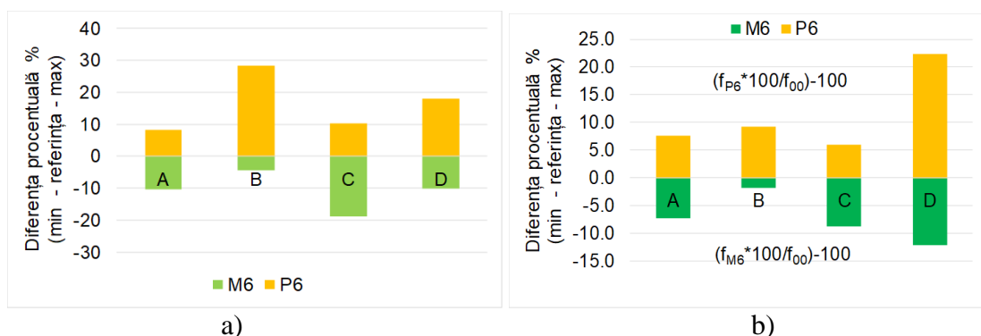
Figura 3.28. Diferența procentuală dintre valorile: a) frecvențelor fundamentale a plăcilor cu grosimea maximă și cea nominală (reprezentare cu galben), respectiv a plăcilor cu grosimea minimă și cea nominală; b) a doua frecvență proprie a plăcilor cu grosimea maximă și cea nominală (reprezentare cu galben), respectiv a plăcilor cu grosimea minimă și cea nominală
