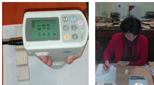
Figura 2.8. Secvențe din timpul măsurării culorii lemnului de rezonanță
