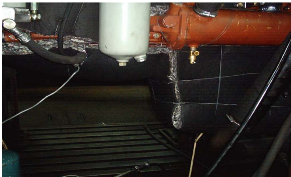
Fig 2.14. Vedere laterală a blocului cilindrilor și a băii de ulei izolate
