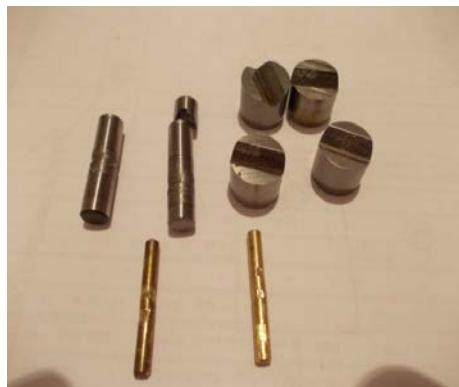
Fig. 3.58. Piesele tribometrului deteriorate
