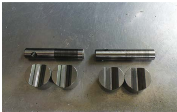
Fig. 3.64. Axul și blocurile în V după test
