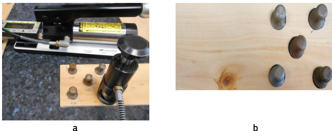
Fig. 4. Echipament de testare tip PosiTest (a); pionii încleiați pe epruvete (b)(Salca ș.a.2016)
