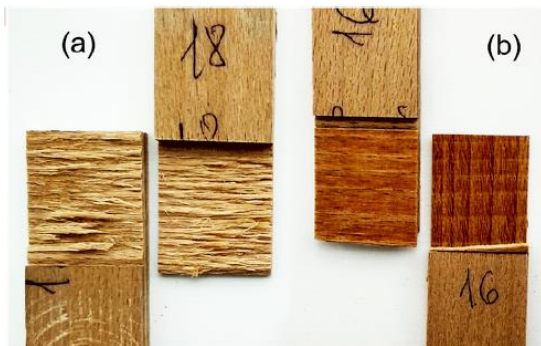
Fig. 17. Modul de rupere la forfecare: a-placaje tip A-G, K-M; b-placaje tip H (Bekhta ș.a. 2020)
