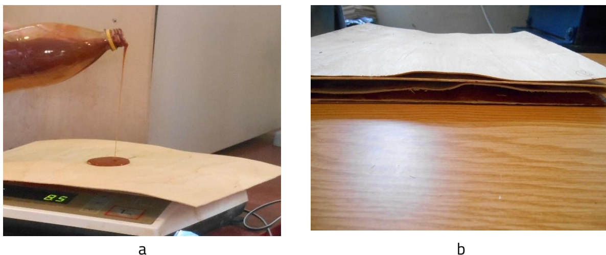
Fig. 4. Măsurarea consumului specific de adeziv (a) și configurarea pachetului de furnire (b)
