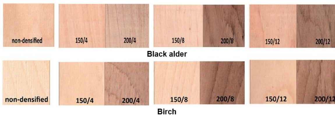
Exemplificare: Modificările de culoare ale furnirelor după densificare la 150°C și 200°C și presiuni de 4, 8 and 12 MPa (Bekhta ș.a. 2014c)
