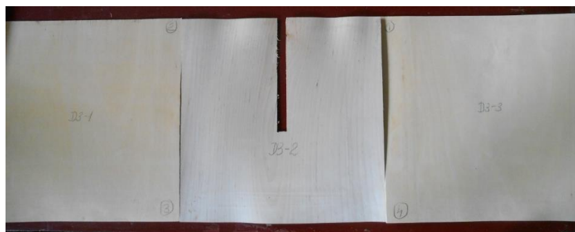
Fig. 5. Pregătirea foilor de furnir pentru placajul cu 3 straturi; decuparea zonei pentru inserarea termocuplului în stratul de mijloc
