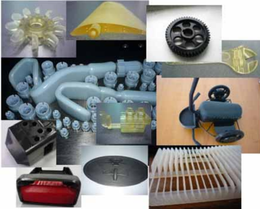
Produse realizate prin tehnologia Polyjet
