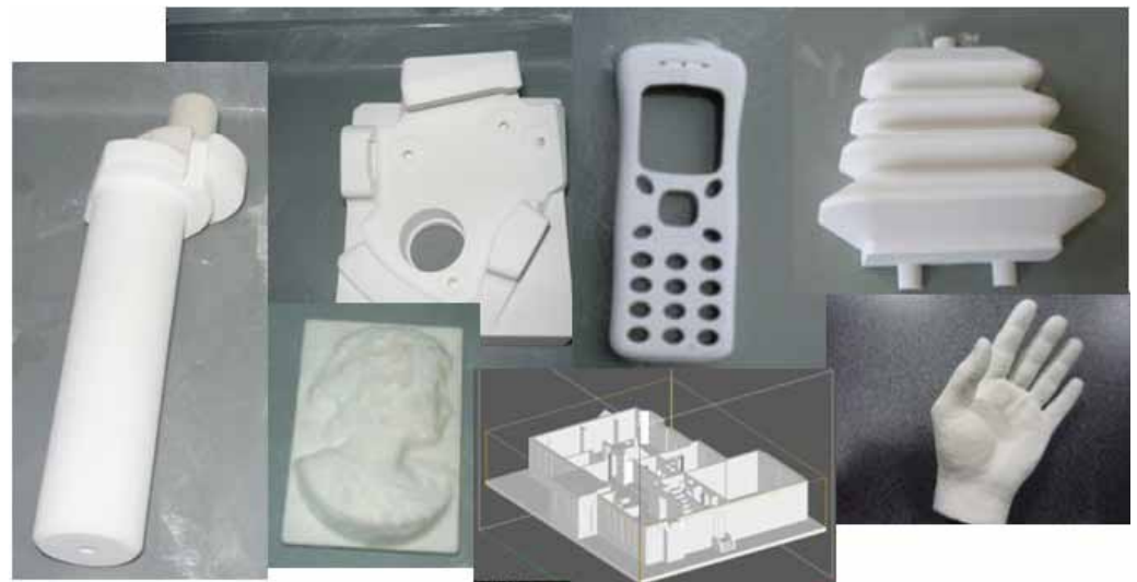
Produse realizate prin tehnologia 3DP
