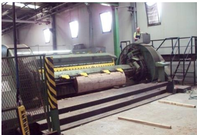
Fig. 2.10 Mașina orizontală de debitat furnir tip Slicer SM-H
