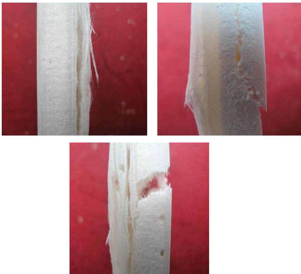
Fig. 2.18. Moduri în care structura sandwich cu miez din poliester neșesut se deteriorează [109]
