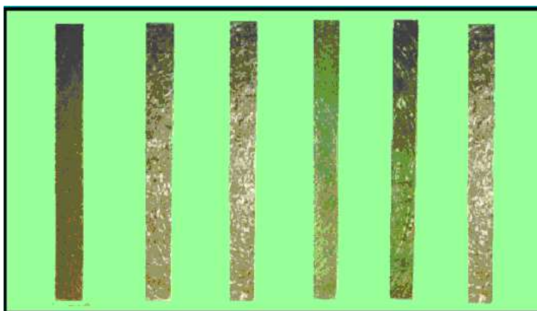
Fig. 2.1. Epruvete din polietilenă cu densitate ridicată (HDPE), armate cu fibră de sticlă [106]
