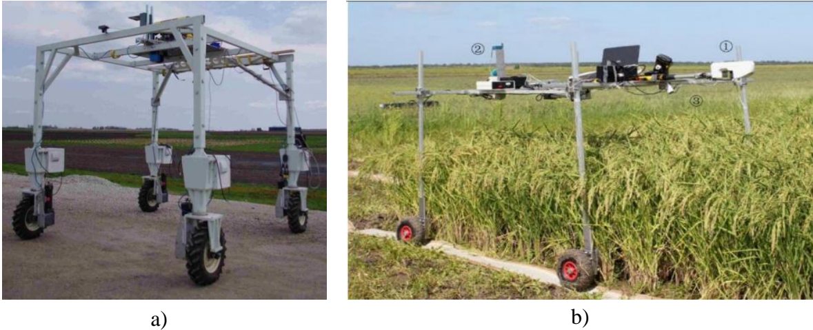
Fig. 20 Platforme mobile pentru monitorizarea stării culturilor a) Platformă mobilă reconfigurabilă [Xiong, 12], b) Platforma mobila autonomă - Unmanned Ground Vehicle System (UGVS) [Wang, 14]
