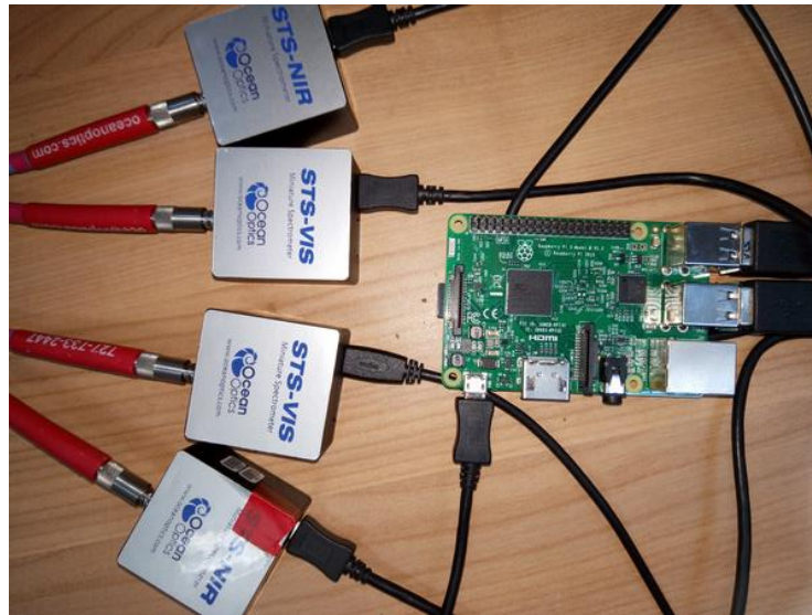
Fig. 12 Conectarea celor patru mini spectrometre la Raspberry Pi3 [Monicult, 16]
