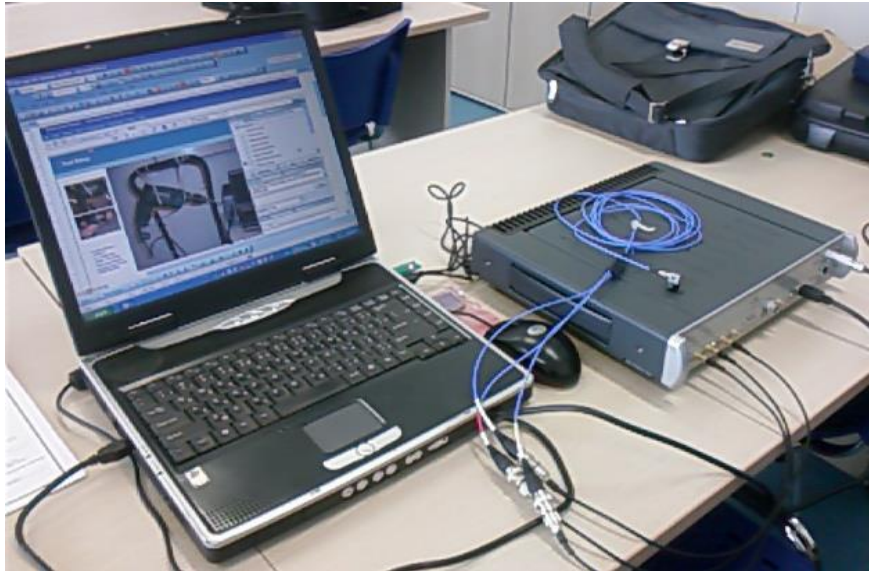
Fig. 40 Sistem de achiziție de date și analiză LMS Pimento [Luculescu, 08c]
