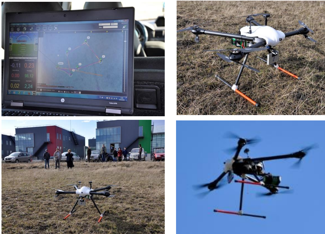
Fig. 27 Modelul funcțional a octocopter-ului (planificare misiuni de zbor folosind Mission Planner și imagini de la testări) [Monicult, 16]
