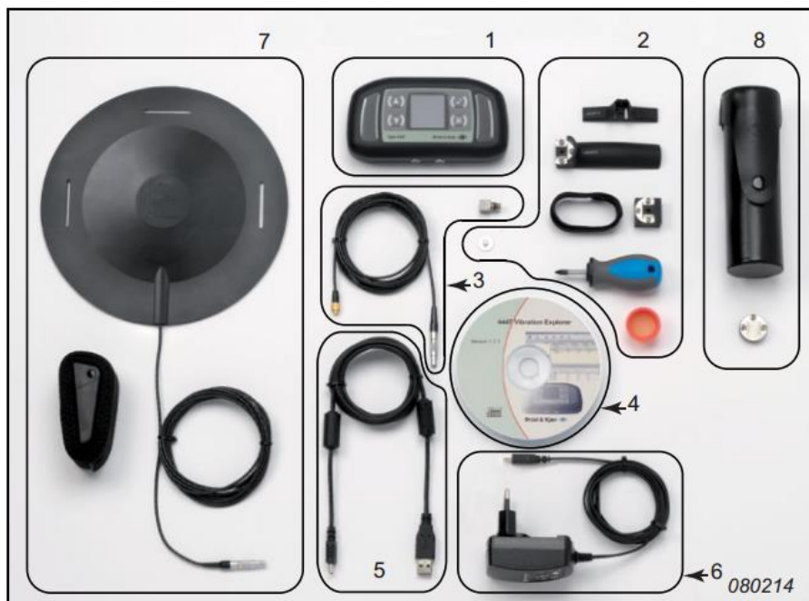
Fig. 41 Analizorul de vibrații umane Bruel & Kjaer tip 4447 [***, 17c]
