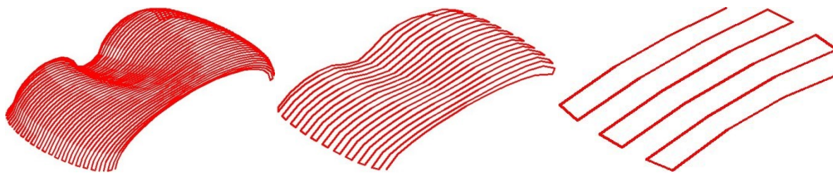
Fig. 1.18 Trasee de prelucrare longitudinale pentru operații de: degroșare –a; semifinisare –b și finisare –c
