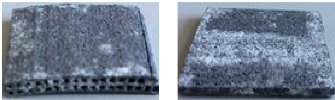
Fig. 2.17 Formarea depozitelor de sare pe suprafața eșantioanelor
