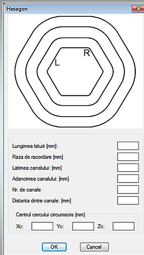
Fig. 1.10 Poziționarea, dimensionarea și multiplicarea canalului
