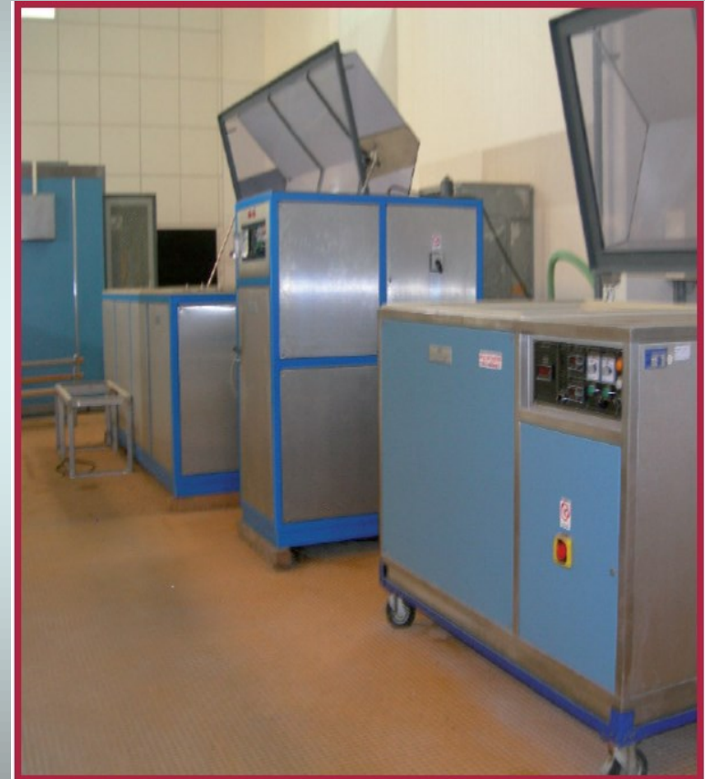
Fig. 2.6 Testarea eșantioanelor prin încercări accelerate în camera climatică și în camera de testare cu atmosferă salină controlată
