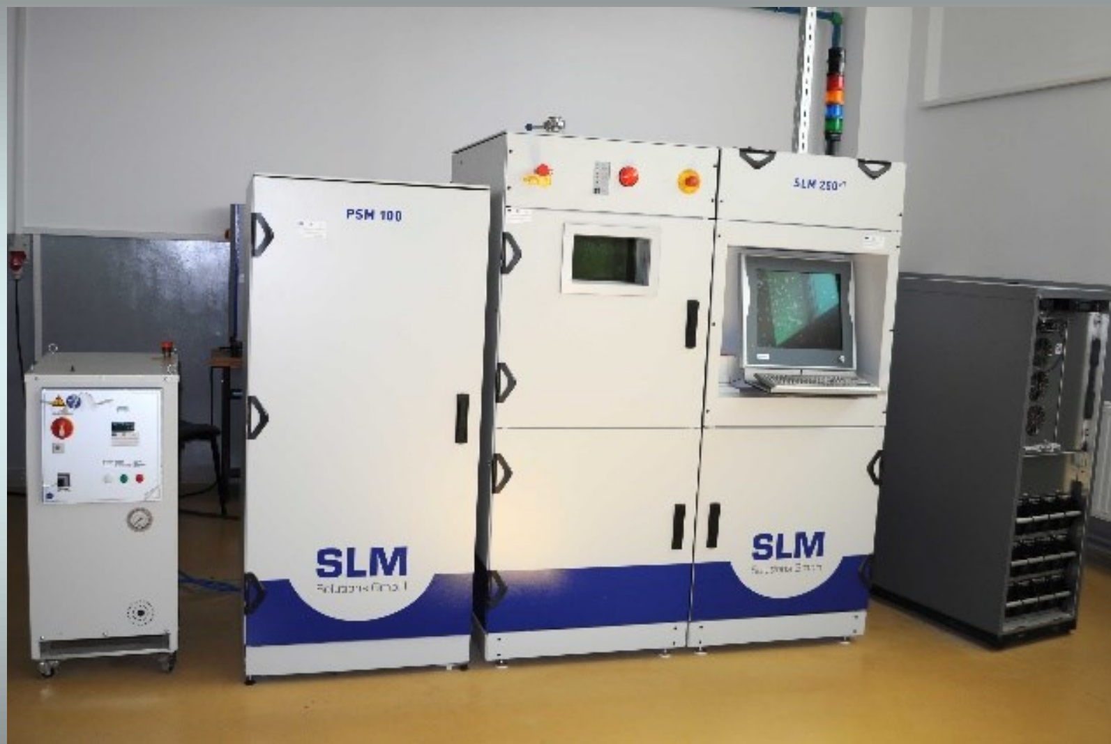
Fig. 2.5 Mașina de topire selectivă cu laser, SLM250HL
