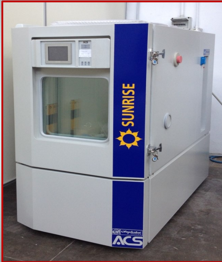
Fig. 2.6 Testarea eșantioanelor prin încercări accelerate în camera climatică și în camera de testare cu atmosferă salină controlată
