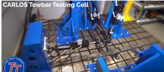
Figura 2.32 - Ansamblu cârligului de remorcă pe standul de încercare
