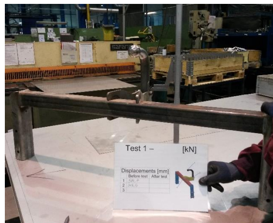
Figura 2.39 - Metoda de măsurare a deplasărilor
