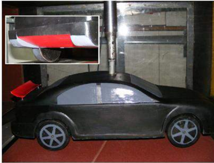
Fig. 1.94 – Macheta de automobil (în camera de experiențe) echipat cu difuzor plan racordat
