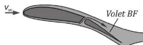
Fig. 2.7 – Controlul stratului limită utilizând fantă bord de fugă (BF)
