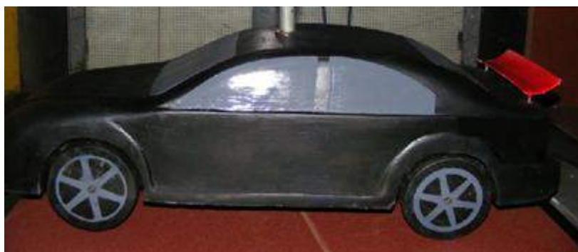
Fig. 2.11 – Macheta automobilului echipat cu eleron în camera de experiențe
