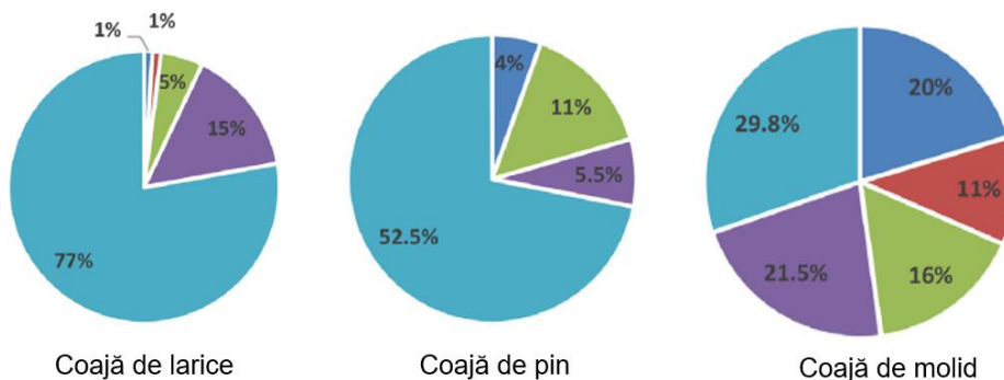
Figura 1.3.1.3. Distribuția particulelor de coajă de conifere cu ajutorul sistemului de mărunțire cu 4 arbori RS 40 (Untha).
