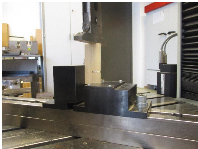
Figura 3.2.3.4 Test de rezistență la forfecare prin compresiune a unei epruvete din lemn de molid
