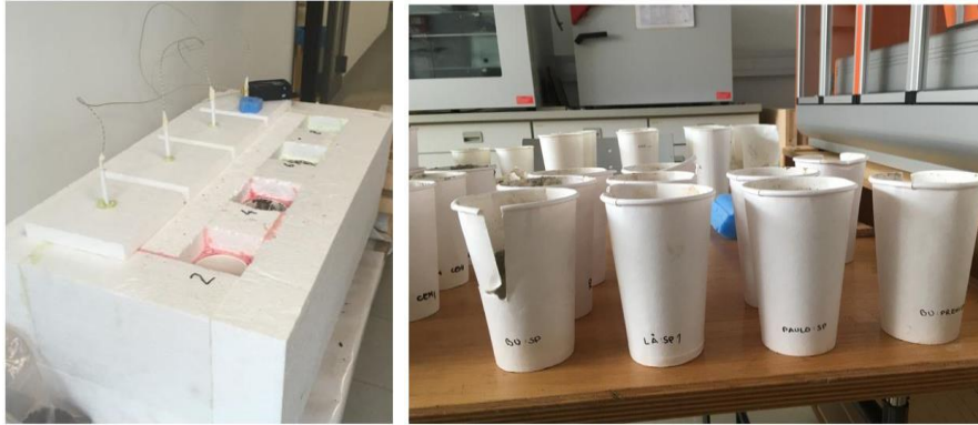
Figura 1.3.4.1. Montaj experimental pentru măsurarea temperaturii de hidratare a compozitelor coajă-ciment
