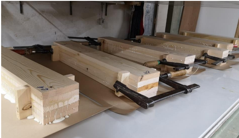
Figura 3.2.3.3. Încleierea la rece grinzilor din lemn stratificat de molid (5 × 20 × 120 × 750 mm) utilizând cu cleme de fixare.
