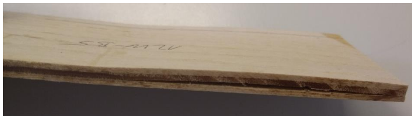
Figura 3.2.1 Placaj tristratificat din furnir estetic de frasin (1,4 mm) încheiat cu adeziv pe bază de cazeină
