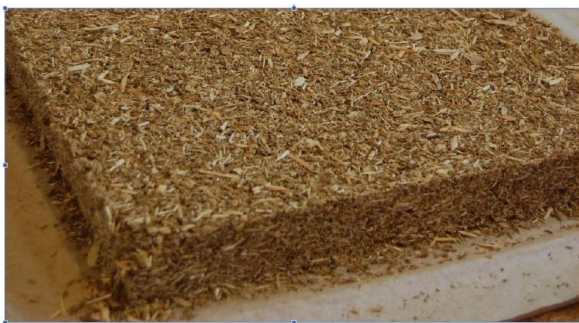
Figura 2.1. Panouri unistratificate de particule de malț cu 50% BSG după formare, înainte de presare la cald.
