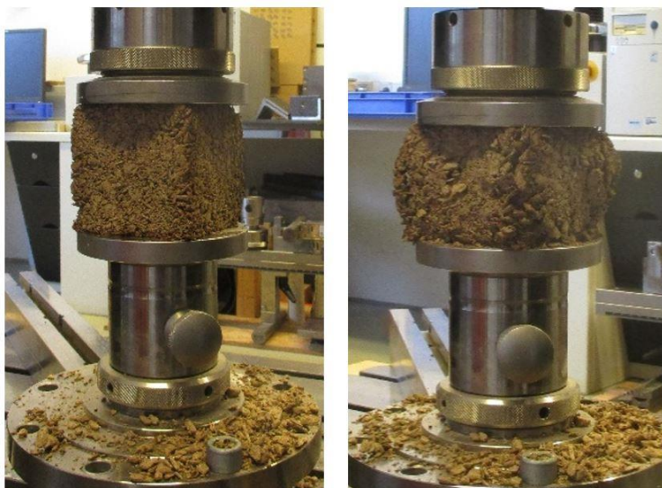
Figura 1.3.4.3. Măsurarea rezistenței la compresiune determinate până la 10 \% compresiune a epruvetei de 100 \times 100 \times 100 \text{ mm} cu ajutorul mașinii universale de testat Zwick/Roell 250.
