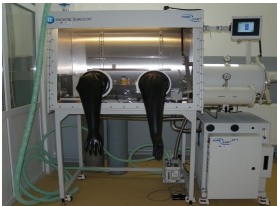
Figura 8.6 Sistem PureLab HE 2GB" boxa cu manusi cu atmosfera controlată
