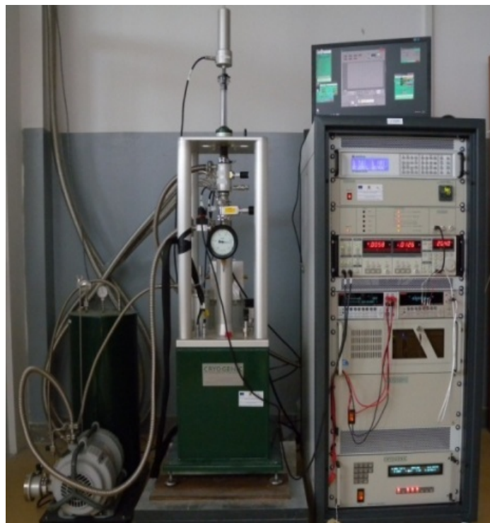
Figura 8.5 Sistemul criogenic pana la 2.5 K pentru studiul proprietăților magnetice, conductivitatilor electrice si termice ale materialelor
