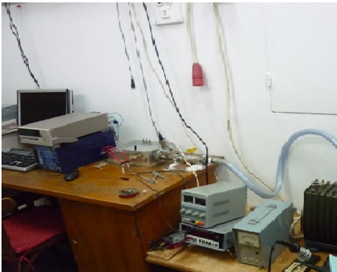
Figura 8.9 Instalație pentru măsurarea și caracterizarea senzorilor de gaz
