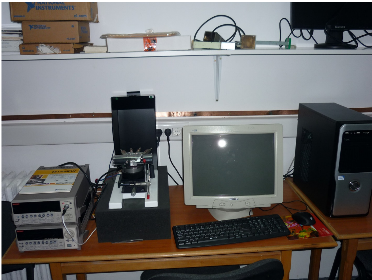
Figura 8.3 Echipament pentru măsurarea rezistivităților electrice prin metoda celor 4 sonde
