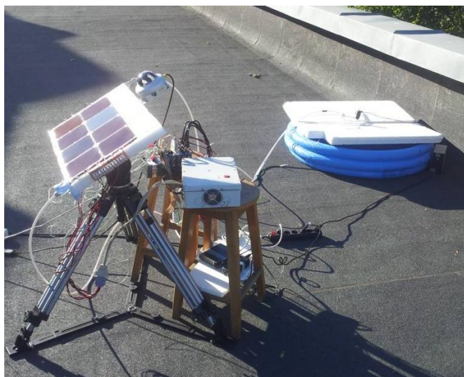
Fig. 67. Sistem hibrid pentru încălzirea apei
