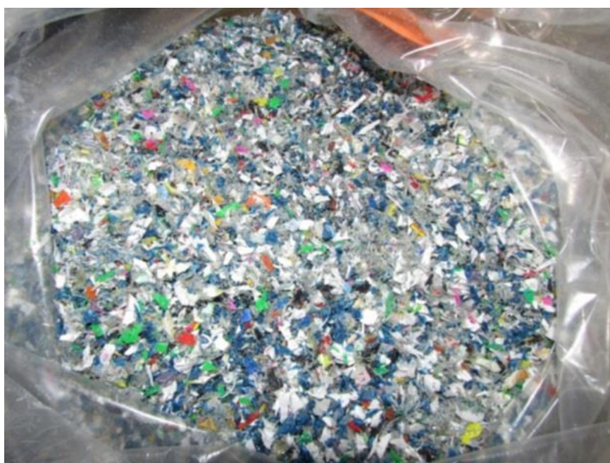
Figura 2.2. Deșeurile polimerice tocate pregătite pentru procesul de separare
