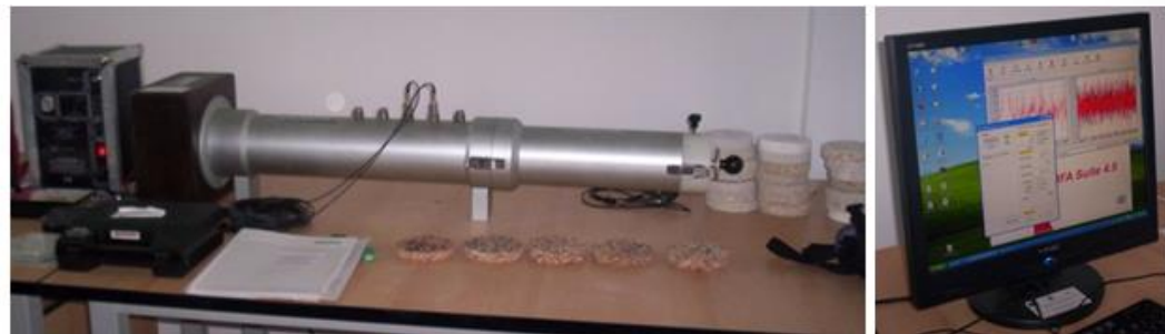
Fig. 3.15. Tubul de impedanță Kundt pe care s-a determinat proprietatea de absorbție fonică a compozitelor din deșeuri de ABS și rumeguș
