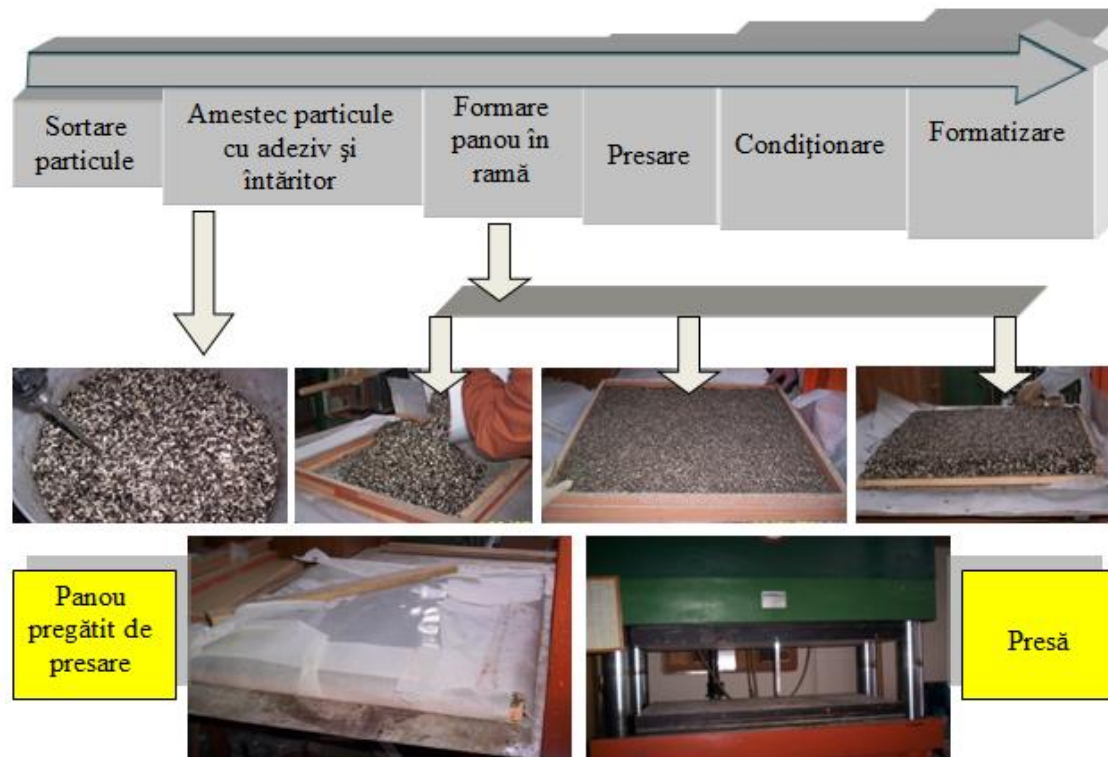
Fig. 1.8. Tehnologia biocompozitelor din coji de semințe de floarea soarelui în condiții de laborator
