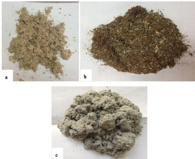
Fig. 2.22. Celuloza măcinată la moara cu ciocănele; a – celuloză din paie de grâu; b – celuloză din tulpini de rapiță; c – celuloză din maculatură reciclată (ziare);
