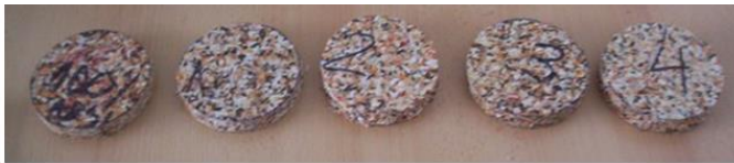
Fig. 3.16. Epruvete cu diametrul de 100 mm pregătite pentru determinarea coeficientului de absorbție fonică
