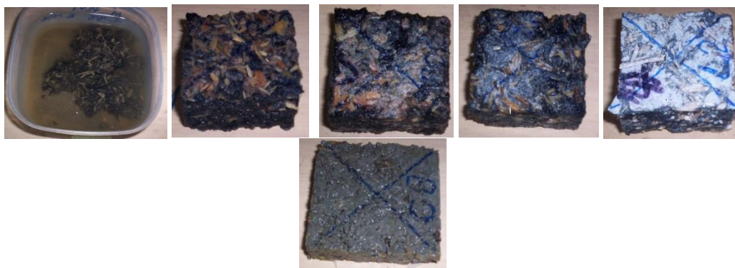
Fig. 3.39. Structurile compozite după 24 h de imersie în apă
