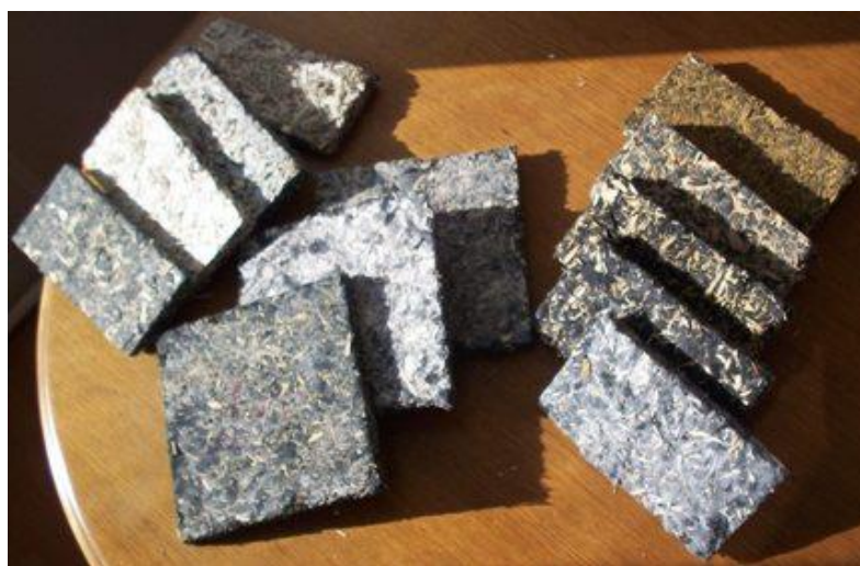
Fig. 3.26. Epruvete rezultate din compozitele termoizolante biodegradabile realizate
