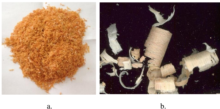
Fig. 3.3. Materia primă din deșeuri utilizată la fabricarea panourilor în condiții de laborator; a. – deșeuri de ABS; b. – rumeguș de la mașina de îndreptat
