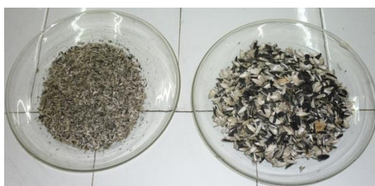
Fig. 1.2. Eșantioane a câte 25 g pentru analiza distribuției mărimii particulelor fine (stânga) și grosiere (dreapta)
