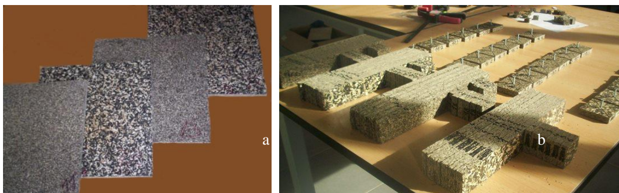
Fig. 1.12. Biocompozite din coji de semințe de floarea soarelui; a. - panouri obținute experimental; b. - epruvete debitate pentru cercetarea experimentală
