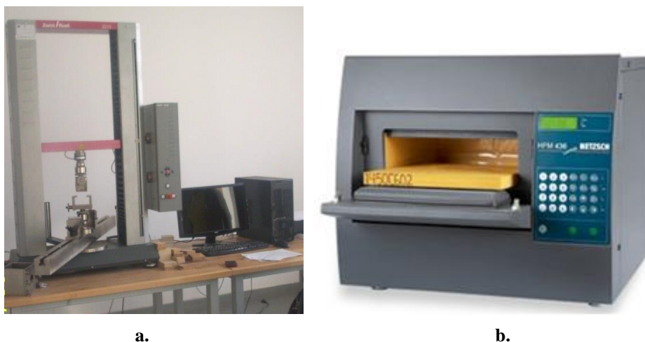
Fig. 1.9. Echipamente utilizate în testarea panourilor din coji de semințe de floarea soarelui; a. - Echipamentul de testare universal Zwick/Roell Z010 pentru determinarea caracteristicilor mecanice ale biocompozitelor; b. - echipamentul HFM 436/6/1 Lambda pentru măsurarea coeficientului de conductivitate termică ( \lambda )
