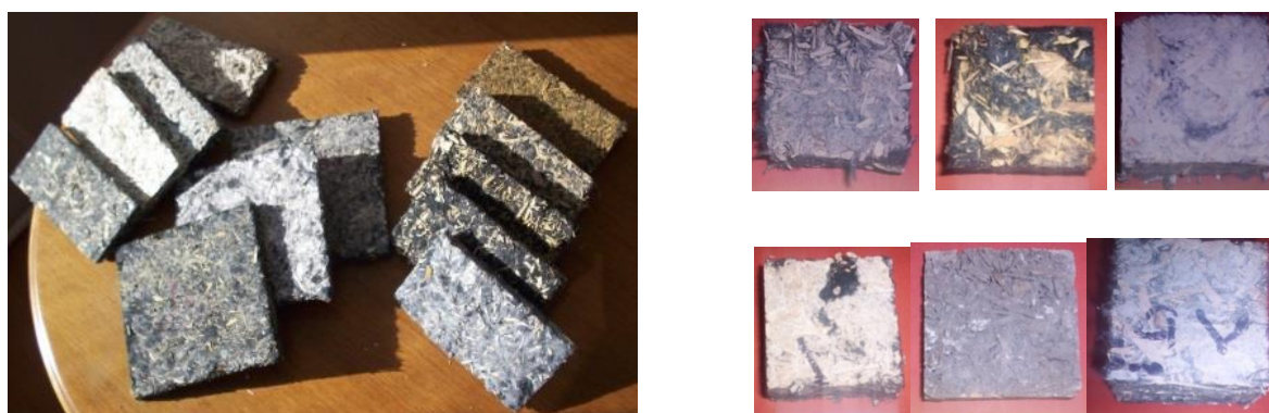
Fig. 3.36. Epruvete ale compozitelor termoizolante, pregătite pentru imersie în apă timp de 4 h
