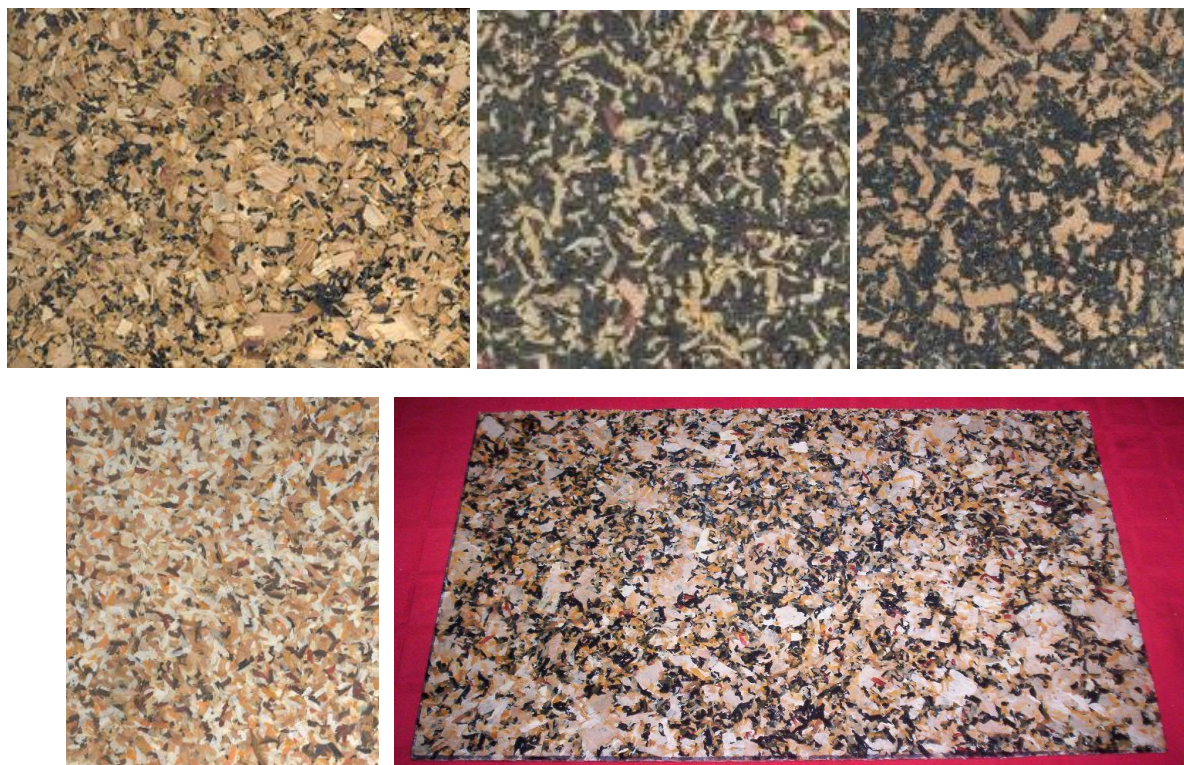
Fig. 3.8. Desenele diferite ale panourilor din deșeuri de ABS, în funcție de culoarea particulelor componente
