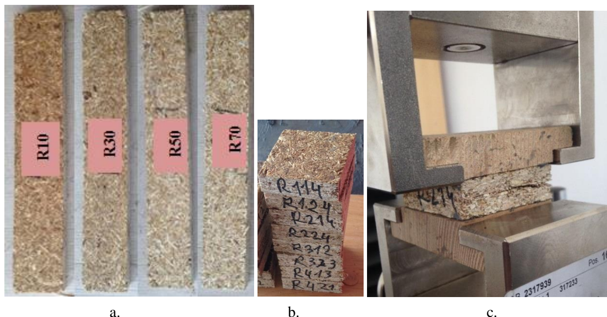
Fig. 1.22. Epruvete pregătite pentru determinările experimentale; a. – la încovoiere; b. – la imersie în apă 24 h și densitate; c. – la tracțiune perpendiculară pe fețele panoului (coeziune internă).
