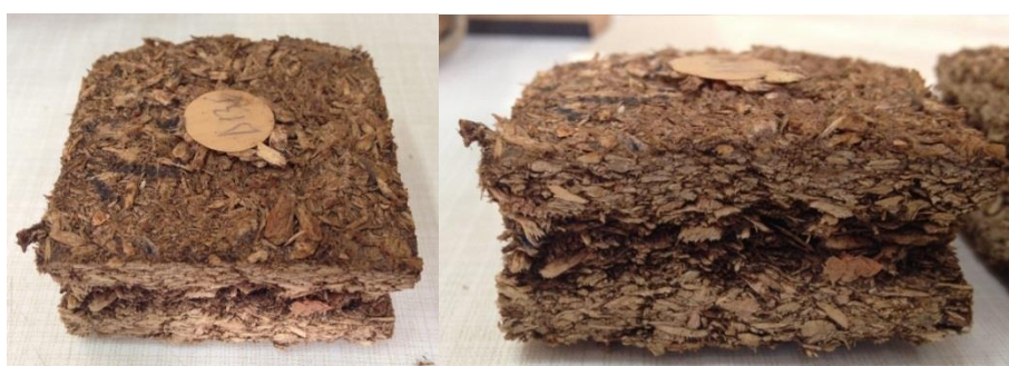
Fig. 2.4. Epruvete cu structura dezintegrată după imersie în apă timp de 24 h
