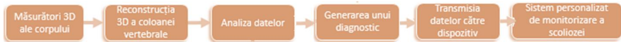
Fig. 74 Configurarea unui sistem de monitorizare a tulburărilor de postură a coloanei vertebrale
