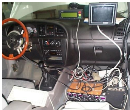
Fig. 2.33 Amplasarea în habitacul autoturismului, a principalelor elemente componente ale sistemului complex de măsurare și achiziții de date.
