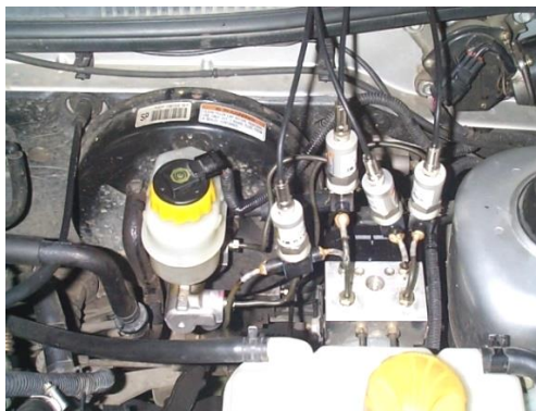
Fig. 2.36 Traductoare pentru măsurarea presiunilor din circuitele de frânare.
