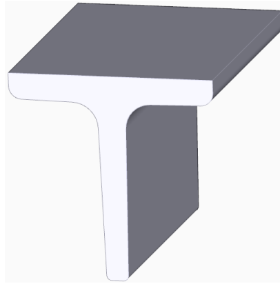
Fig. 4.14 Profilul elementului de susținere.
