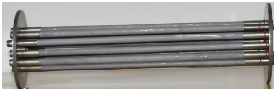
Fig. 6.54 Fixare tuburi curgere gaze de evacuare.
