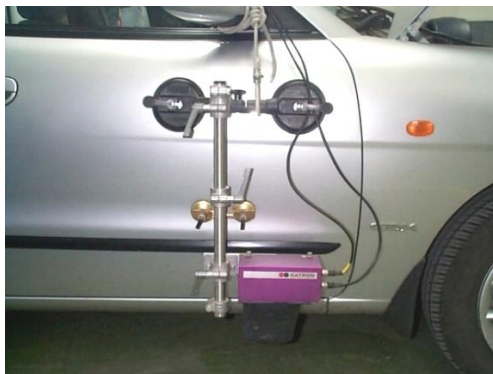
Fig. 2.35 Traductor DATRON V Senzor, utilizat pentru măsurarea vitezei autoturismului.
