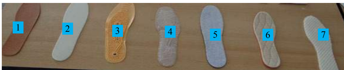
Fig. II.2.46. Mostrele de branțuri (forma și suprafețele de contact cu piciorul și încălțăminte) 1. Branț cu carbon activ, 2. Branț cu spumă și carbon activ, 3. Branț de silicon cu pastile magnetice, 4. Branț cu gel, 5. Branț cu spumă, 6. Branț din poliuretan, cu lână și folie de Al., 7. Branț cu lână și latex [23]
