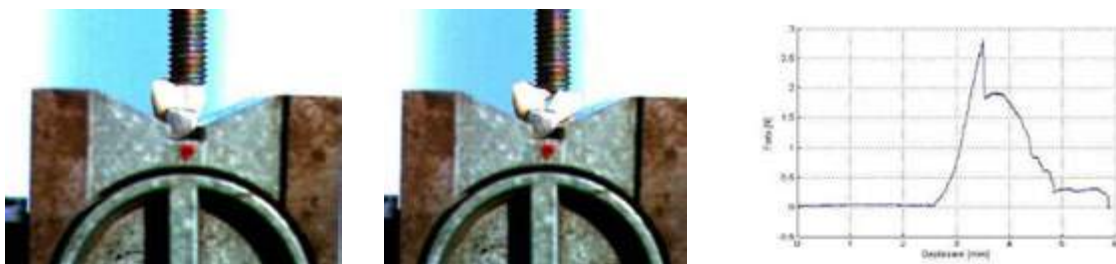
Debutul ruperii materialului dintelui Momentul ruperii elementului de protezare Graficul variației forței de compresiune în raport cu deplasarea
