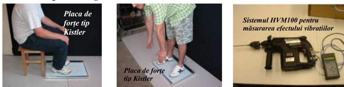
Fig.III.1.2. Pozițiile inițiale ale subiecților – fără unealta vibratorie și respectiv măsurarea nivelului de vibrații pe unealta vibratorie
