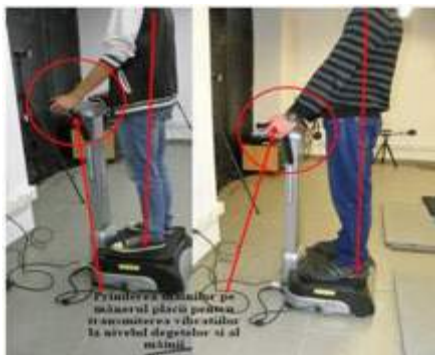
Fig. III.1.11. Expunerea controlată la vibrații prin intermediul unei plăci vibratorii
