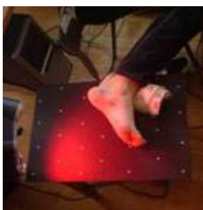
Fig.II.2.41. Scanarea suprafeței plantare [55]
