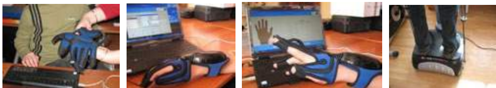
Fig.II.3.7. Montajul, calibrarea și înregistrarea datelor inițiale ale mănușii senzoriale și apoi expunerea la vibrații
