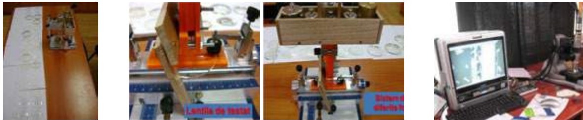
Fig.III.3.2. Eșantionul de lentile, sistem de realizat degradări ale suprafețelor și microscopul digital
