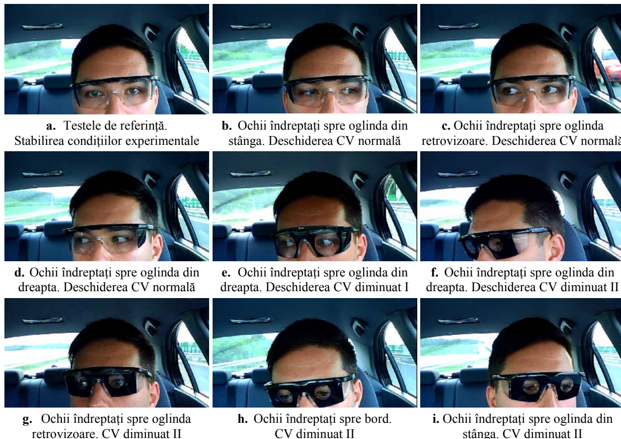
Figura I.3.7. Teste experimentale pentru simularea comportării în trafic a unui conducător auto cu CV diminuat
