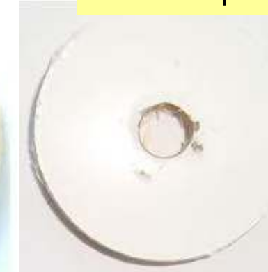
WF Ra=14.38 μm
